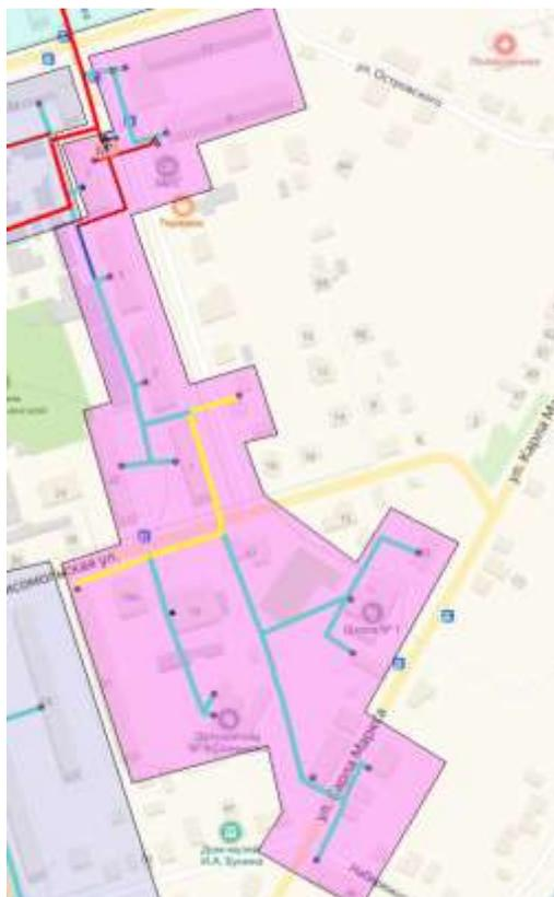
Рисунок 23. Место расположения ЦТП и зона его действия.
