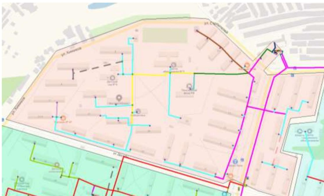
*Рисунок 5. Место расположения ЦТП и зона его действия.*
