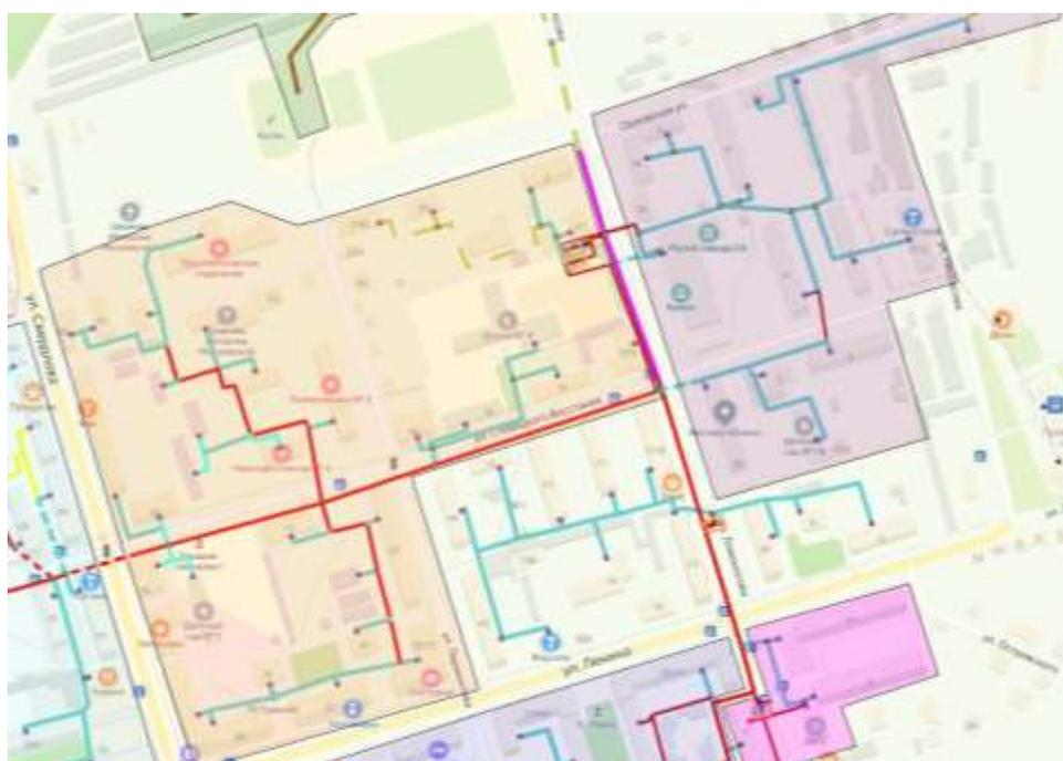
*Рисунок 30. Место расположения ЦТП и зона его действия.*
