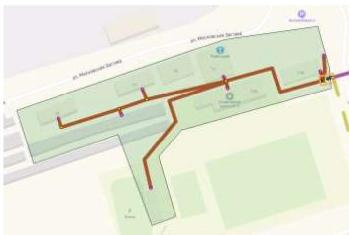
Рисунок 21. Место расположения ЦТП и зона его действия.
