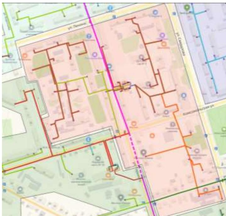
*Рисунок 33. Место расположения ЦТП и зона его действия.*
