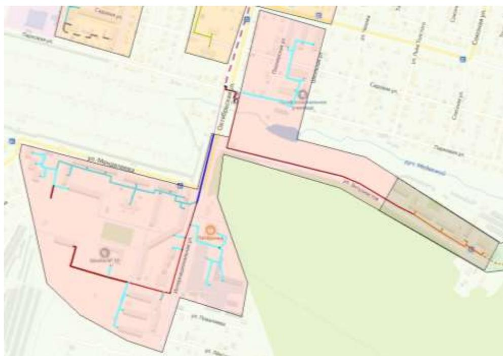
*Рисунок 28. Место расположения ЦТП и зона его действия.*
